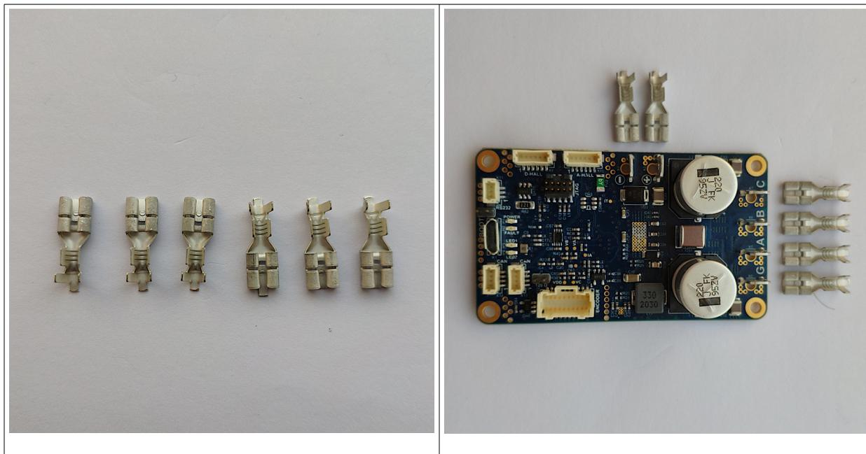
Комплект состоит из 6шт одинаковых разъемов<sup>1</sup>. Разъемы предназначены для подключения электропитания, трех фаз и «земли» бесколлекторного двигателя к контроллерам СЕРВОСИЛА SC-25.
