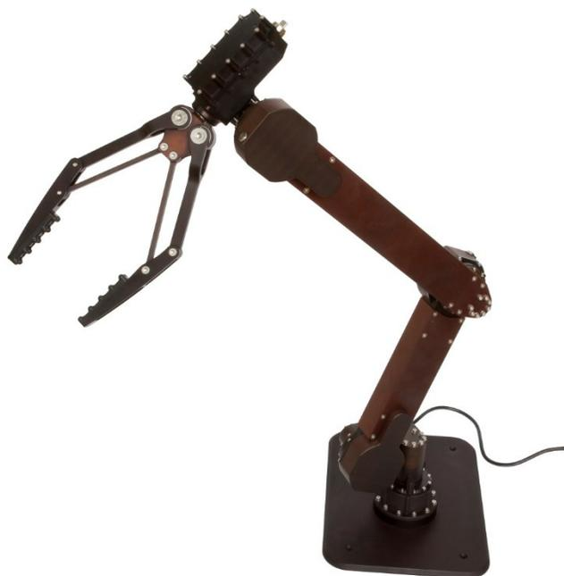
Робототехнические манипуляторы Сервосила предназначены для оснащения мобильных сервисных роботов, а также для проведения научных исследований в области систем управления сервисными роботами с искусственным интеллектом.
