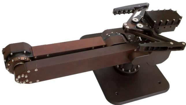
На шасси мобильных роботов всегда мало места, а манипулятор может быть не единственным модулем полезной нагрузки. По этой причине у манипуляторов Сервосила предусмотрена возможность складывания в очень компактное по объему и габаритам состояние. В сложенном состоянии манипуляторы Сервосила занимают минимум места, не мешают работе других модулей
