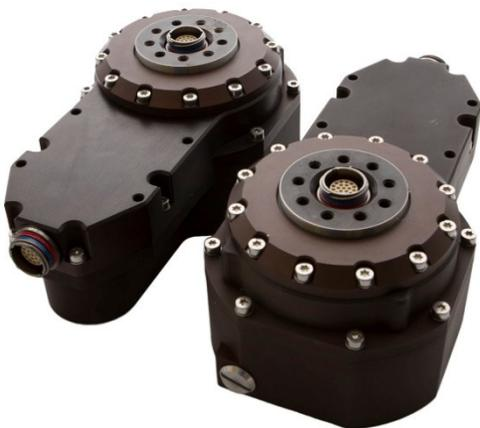
Робототехнические манипуляторы Сервосила сделаны на основе интеллектуальных сервоприводов разработки компании Сервосила. В основе сервоприводов лежат малогабаритные бесколлекторные двигатели, управляемые микропроцессорными контроллерами согласно векторному закону управления. Волновые редукторы обеспечивают минимальный люфт выходного вала, а также малые габариты и массу.
