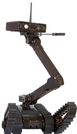
Робототехнические манипуляторы Сервосила неприхотливы к качеству входного электропитания, что очень важно для обеспечения интеграции с мобильными роботами, так как зачастую возможности бортовых систем электропитания мобильных роботов сильно ограничены.
